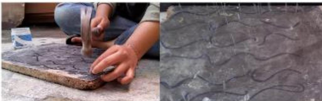
Gambar 6. proses pembentukan cetakan untuk teknik lengkung( dokumentasi penulis)
