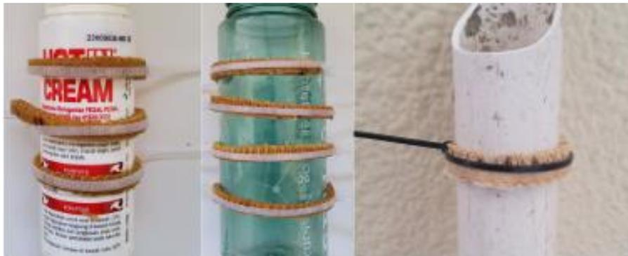
Gambar 5. proses uji coba teknik bending (dokumentasi penulis)
