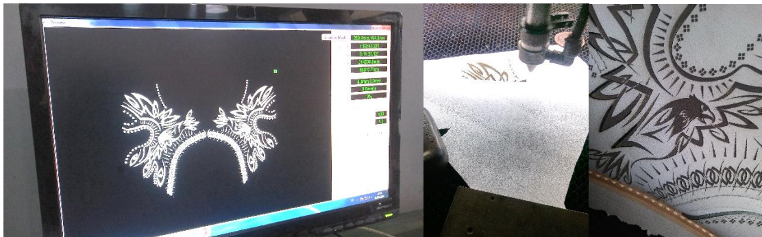
Gambar 5. Proses eksekusi desain modul ragam hias digital menggunakan teknologi laser cutting/ engraving
