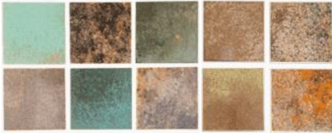
Gambar 11. Sample material KAVA dari cangkang/sekam kopi[13]
