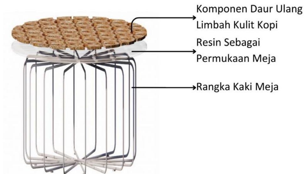
Gambar 8. Ilustrasi Penyusunan Komponen Secara Terurai (Dokumen Pribadi)
