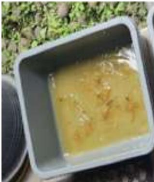
**Gambar. 4 Penuangan Larutan ke dalam Bak Cetak dan Proses Pengeringan (Sumber: Dokumentasi Peneliti, 2022)**
