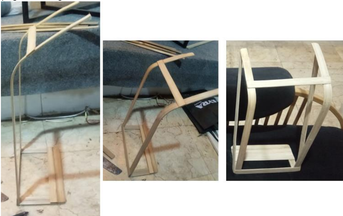
Gambar 9. Perubahan pada konstruksi tas dan tambahan struktur pada bagian samping konstruksi.
