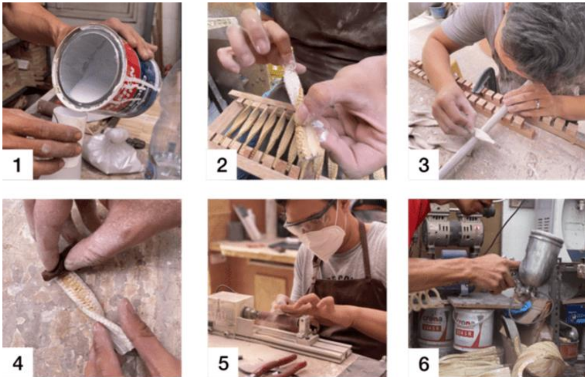
Gambar 8. proses dempul dan finishing (sumber : dokumentasi pribadi)
