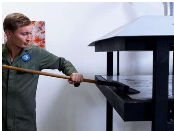
Gambar 9. pengangkatan hasil sheetpress dari mesin hidrolik (sumber : precious plastic.com)
