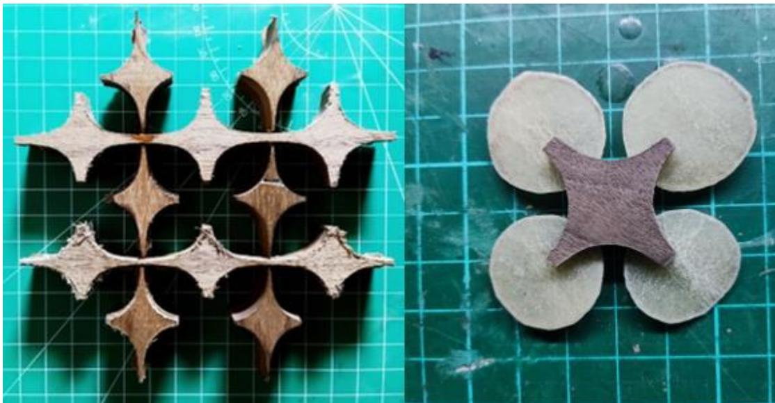
Gambar 9. penggabungan antar modul dengan teknik *jointing* dan teknik kombinasi dengan material kulit perkamen
