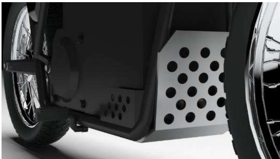
Gambar 19. 3D Skidplate (Sumber : dokumentasi pribadi)
